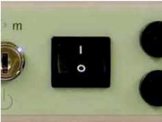
Das Einschalten des Gerätes erfolgt durch Drücken des Wippschalters in Stellung I.
