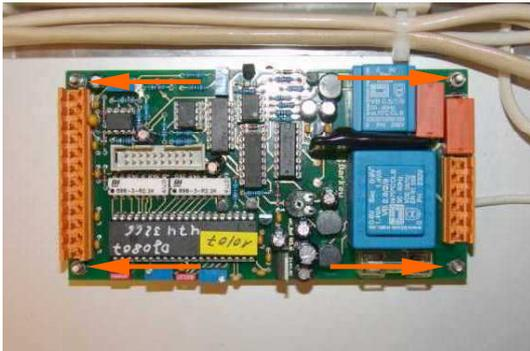
Abbildung 18: Befestigungsmuttern Regelungsplatine
