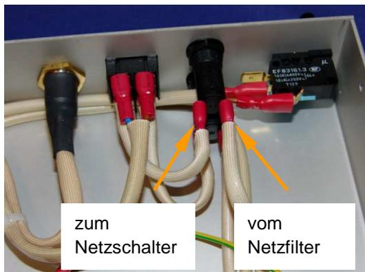
Abbildung 34: Anschluß Sicherungshalter
