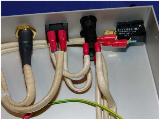
Abbildung 37: Isolierung Schlüsselschalter
