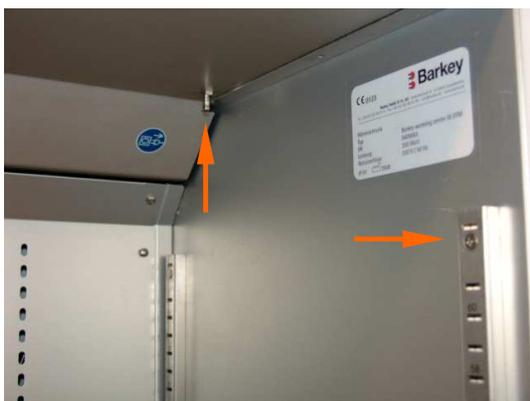
Im nebenstehenden Bild sehen Sie die Meßpunkte, mit denen die Prüfsonde des Prüfgerätes für die Messung von Schutzleiter- und Isolationswiderstand verbunden werden muß.
