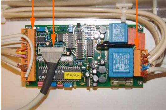
Abbildung 17: Steckverbinder auf Regelungsplatine
