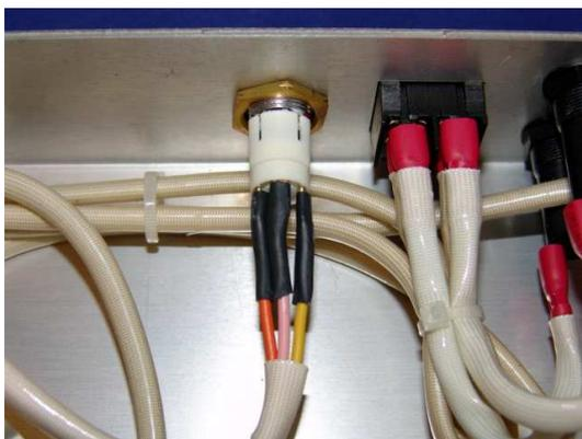
Abbildung 36: Anschluß Schlüsselschalter
